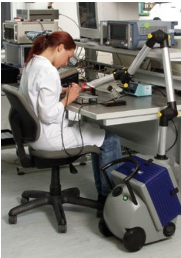
Рабочее место для ручной пайки с устройством вытяжки и фильтрации
